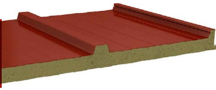
Panel de tres grecas con tapa-juntas que proporciona además de las características del panel tradicional (con aislamiento de poliuretano): estanqueidad, aislamiento térmico, facilidad de montaje y las ventajas de un aislamiento de lana de roca ignífuga.
